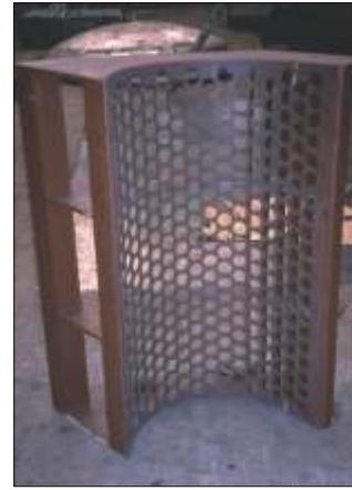
Criba construida con nuestro Acero Alresist 512 ®
